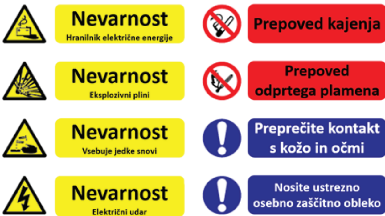
Slika 33: Nalepka za označevanje hranilnikov električne energije (velikost nalepke najmanj A4)
